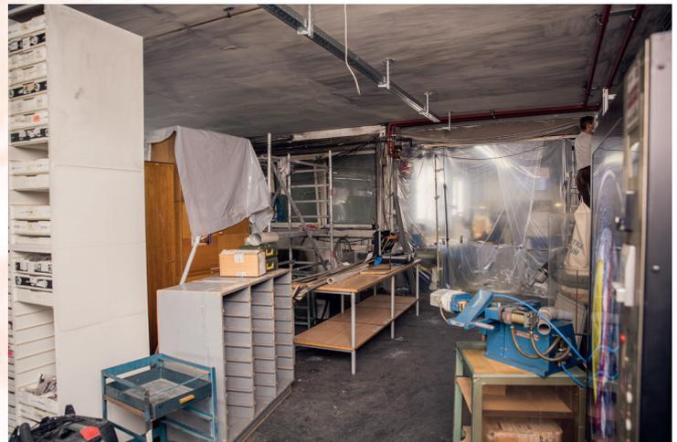
Der Ruß wird so gut es geht von den Spezialisten der Firma Belfor bekämpft. Jede einzelne Maschine und jedes Teil wird sorgfältig geputzt um dem Verrosten entgegenzuwirken.
